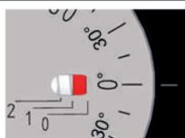
Indicateur en position 1 / Pression moyenne
