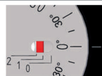
Indicateur en position 2 / Haute pression
