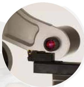
Caméra Haute Définition avec objectifs télécentriques. Champs de vision 7 x 7 mm. Agrandissement 40x. Mesure de l'outil avec une résolution de 0,001 mm et inspection en mode Real View possible.
