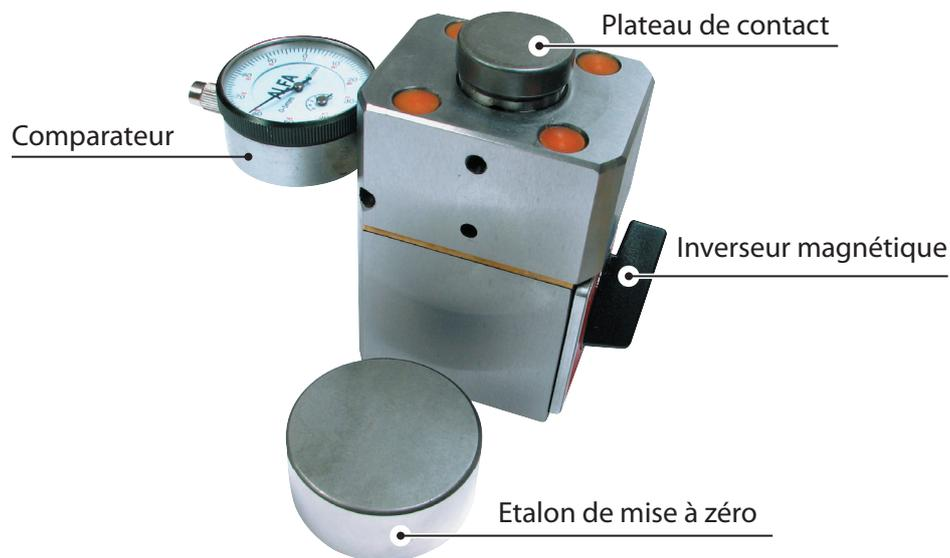
1. Avant toute opération nettoyer correctement la face d'appui, le plateau de contact et l'intérieur de l'étalon.
